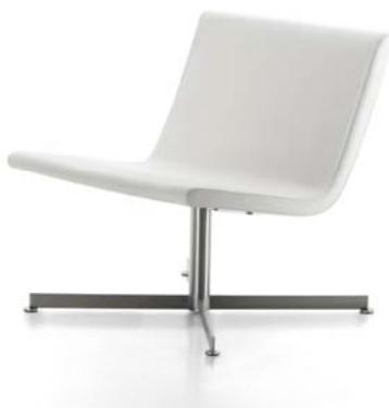
**Caractéristiques techniques:****Coque en bois multiplis de hêtre, épaisseur 10 mm, entièrement tapissée.****Mousse: Densité 40 grs. épaisseur variable, assise maxi 25mm, dossier 45 mm.****Tissu client: 1,75 x 1,40m.**
