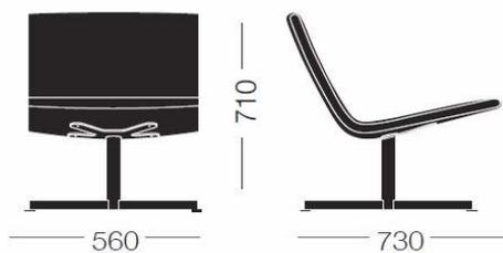
**Structure:****Colonne diamètre 487 mm.****Branches section 35 x 8 mm.****Tout en acier inoxydable.**
