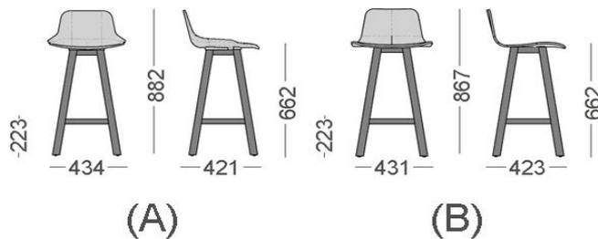
**ARMAZON****4 patas de madera de haya cilíndricas y un soporte de madera de haya para soportar la carcasa.
